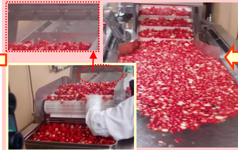
⑤ 殺菌後コンベアーにて搬送。 コンベアー上部よりカンファ水シャワーリング
