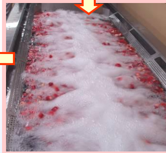
⑥ 洗浄機にて高圧攪拌させ殺菌する。 (まんべんなくカンファ水に接触させる。)
